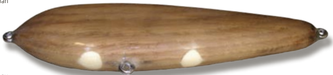
Bild 3. För att fylla ut håligheten i förtyngningkamrarna använder Fredrik kemiskt trä som lätt kan slipas ned i höjd med betets kant redan efter en halvtimme. Betet ovan har även fått ett lager skyddslack innan det målas.
