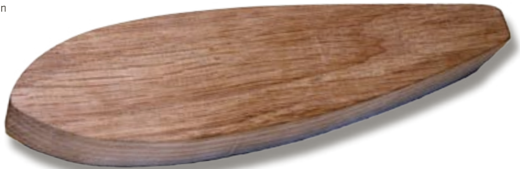
Bild 1. Börja med att rita ut betets kontur på en brädbit. Efter att ha sågat ut betet är det dags att runda av kanterna med kniv eller rasp. När man är nöjd med formen använder man fil eller sandpapper för att få en fin finish.
